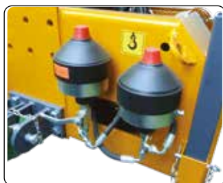
Accumulatori di azoto. Lift float nitrogen accumulator.
