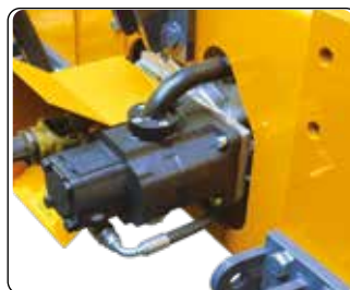
Pompa in ghisa ad ingranaggi. Gear pump.
