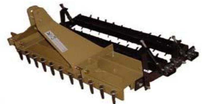
**\* COMES ASSEMBLED, READY TO USE \* QUICK HITCH READY \* ALL WELDED FRAME IS HEAVY DUTY 10" X 10" WIDE FLANGE BEAM \* ROLLER ROTATES ON A 1" SHAFT ON FLANGED REGREASABLE PILLOW BLOCK BEARINGS \* SPRING LOADED ROLLER HAS 1 3/8" LONG PINS WELDED TO A 6" TUBE \* 3 POINT CLEVIS TYPE HITCH WITH CAT. 1 REPLACEABLE LIFT ARM PINS**
