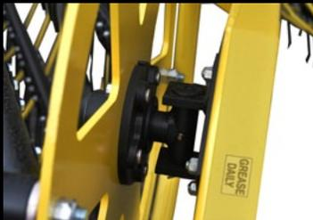
SELF-ALIGNING IDLER HUBS
