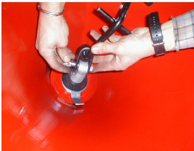
11) Fissare l'agitatore superiore con nr 1 VITE TE 12x50 e nr 1 DADO AUT. M12
