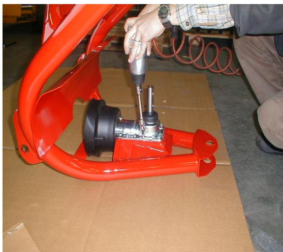
1) Fissare il riduttore sull'apposita staffa del telaio con nr 6 VITE TCEI 8x16
