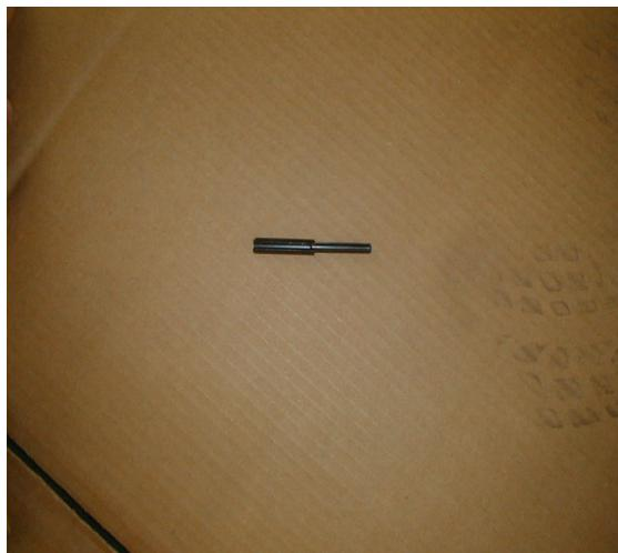
2 a) Utilizzare le spine 5x40 e 8x40 per fermare il disco spargitore sull'albero del riduttore
