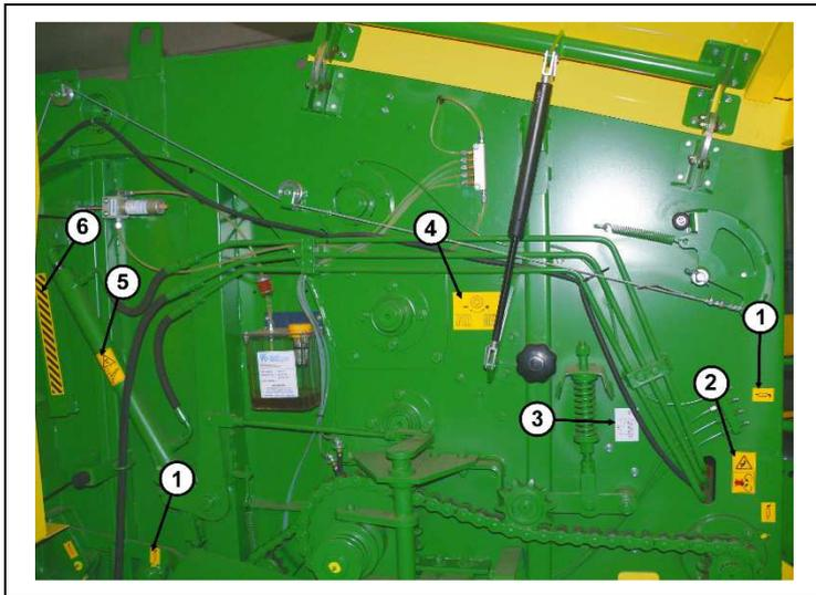
**FIG. 32. PICTOGRAMS AND LABELS VISIBLE ON THE RIGHT SIDE OF THE BALER (UNDER THE COVERS).**
