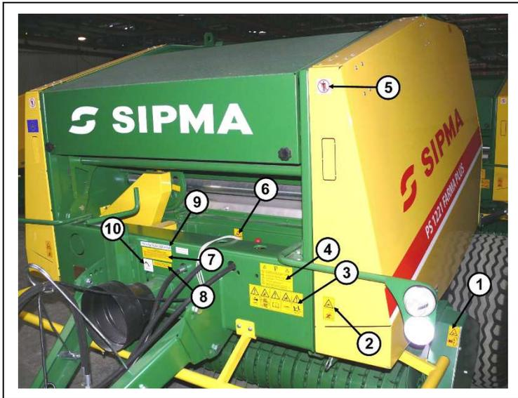
**FIG. 28. PICTOGRAMS VISIBLE ON THE FRONT LEFT SIDE OF THE BALER.**
