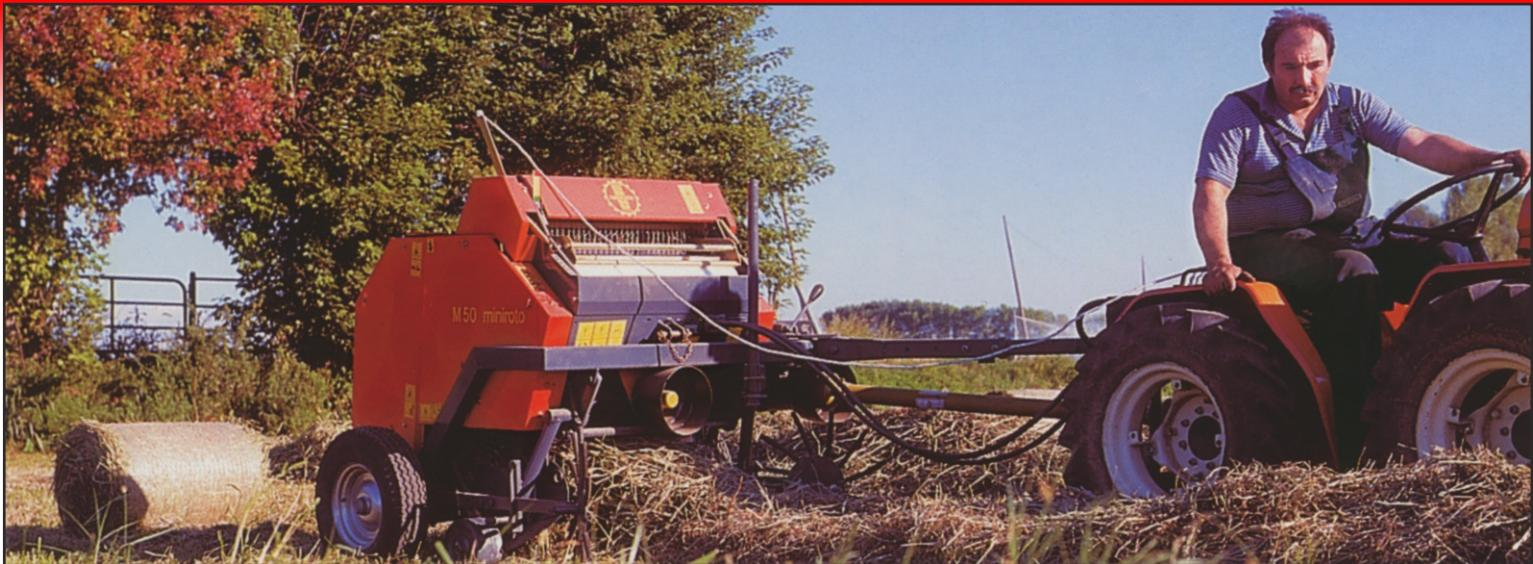
**F** La M50 MINIROTO est une presse à balles rondes à rouleaux avec presse fixe. L'encombrement et les poids minimums en font une machine particulièrement adaptée pour l'emploi dans les zones de montagne et pour l'élevage de chevaux.
