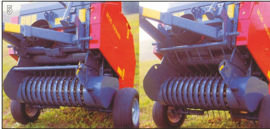
**I** **4.** La camera di compressione a rulli è fissa. L'allontanatore (di serie) consente di scaricare la ballo oltre il raggio di chiusura del portellone.
